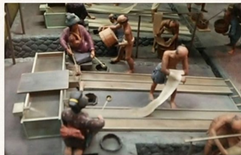
⑤ 鉱石を水で流して選別する工程(ねこ流し)
