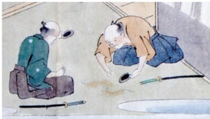
試金石・試金棒で金の品位をはかる様子
