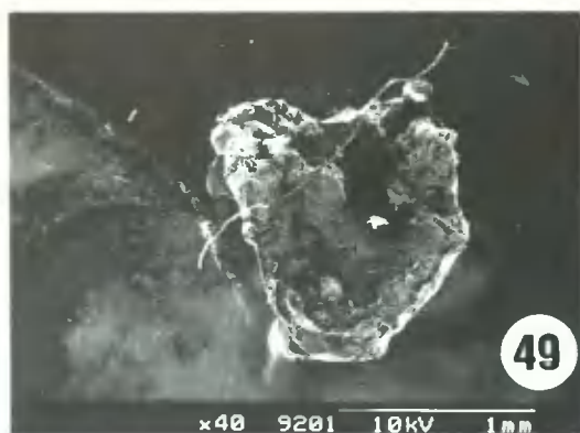
図版Ⅷ コメ状付着粒(実体顕微鏡写真) 小粒状付着粒・ベタ状中粒状・採取粒(走査型電子顕微鏡写真)
